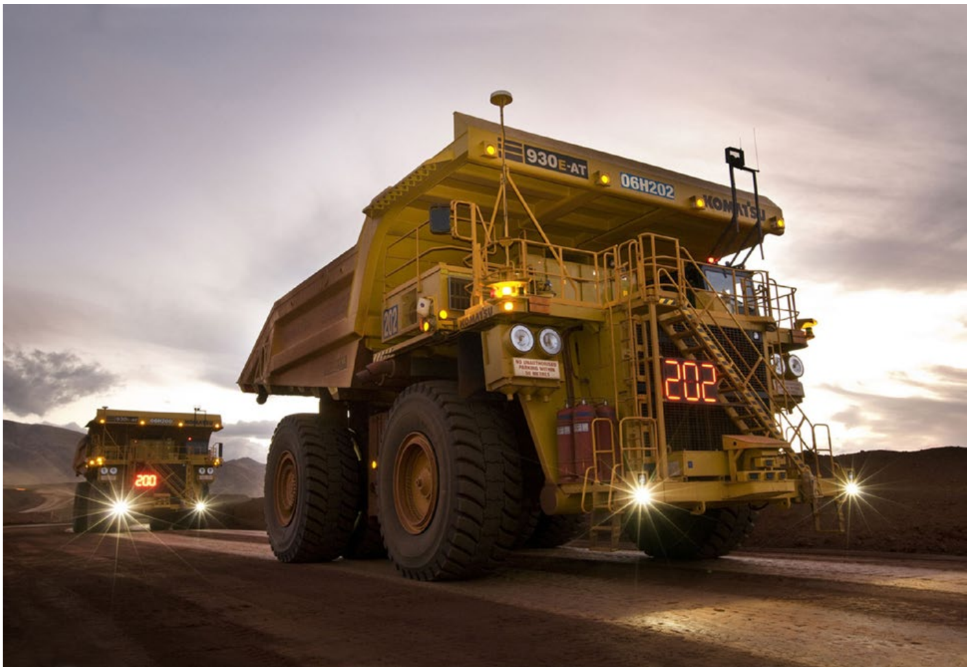
鉱山で稼働する無人ダンプトラック(提供:コマツ)
