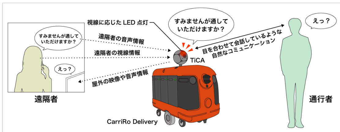
宅配ロボットと遠隔コミュニケーションデバイスによる実証実験の仕組み
