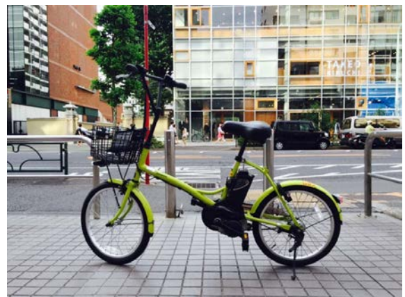
実験で使用するシェアサイクル。スマホで施錠できるスマートロックとGPS機能を装備。
