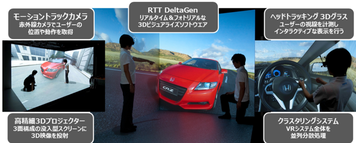
図：本田技術研究所に導入した VR システムの構成
