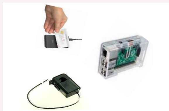
同社が活用する小型シングルボードコンピュータ及びICカードリーダー、電流センサー
