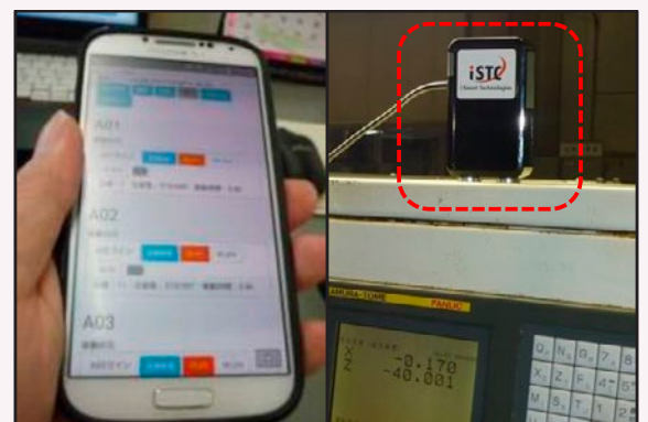
製造ライン遠隔モニタリングの端末画面（左）と工場内の送信機（右）
